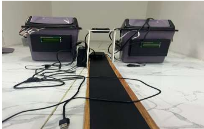
Gambar 5. 1 Alat Pemilah sampah Otomatis dan Monitoring Volume
