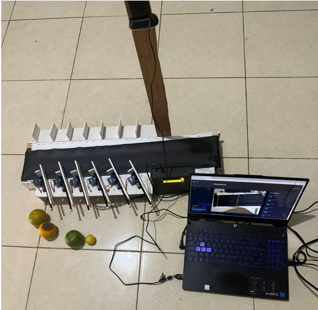
Gambar 5.1 Implementasi Mekanik Konveyor dan Dudukan Kamera
