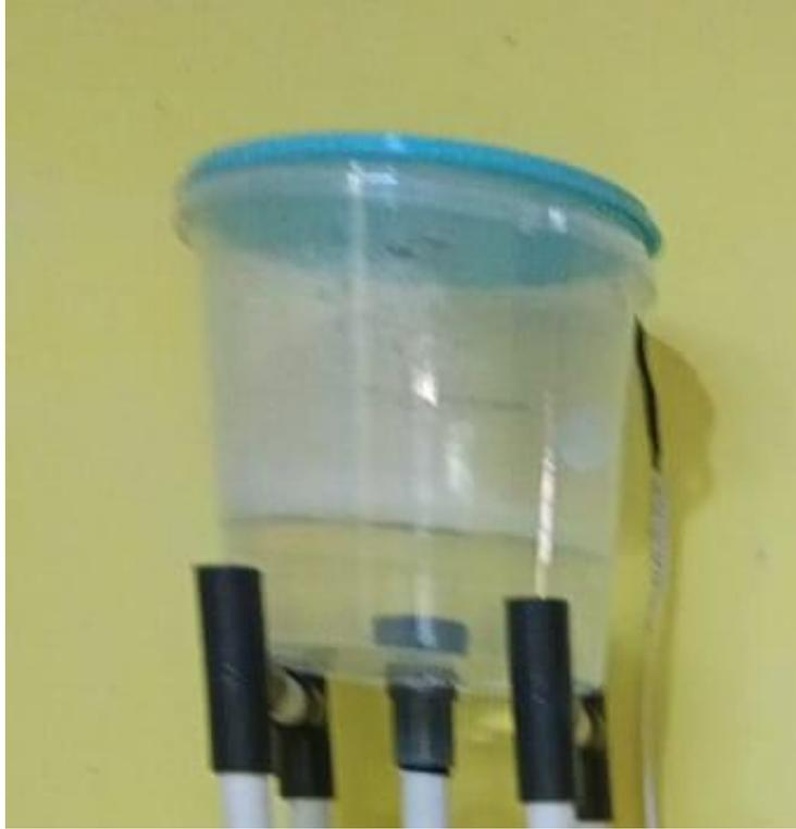
**Gambar 5.1 Posisi HC-SR04 Untuk Mendeteksi Ketinggian Air**
