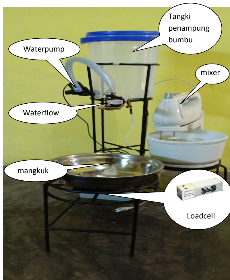
Gambar 5.1 Prototype penakar dan pengaduk bumbu otomatis
