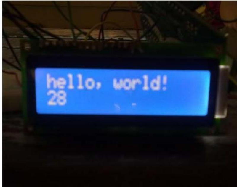
**Gambar 5.4** Pengujian LCD 16x2
