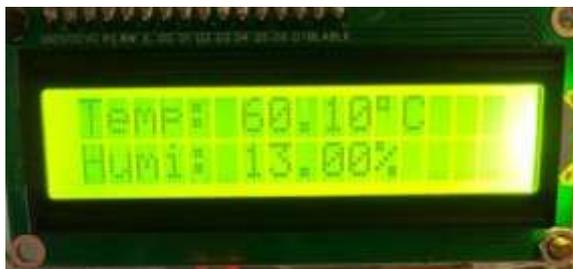
**Gambar 5. 8 Pengujian LCD 16x2**
