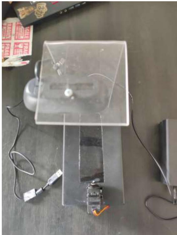
**Gambar 5.2 Gambar Penempatan Kamera dan Juga Motor Servo**
