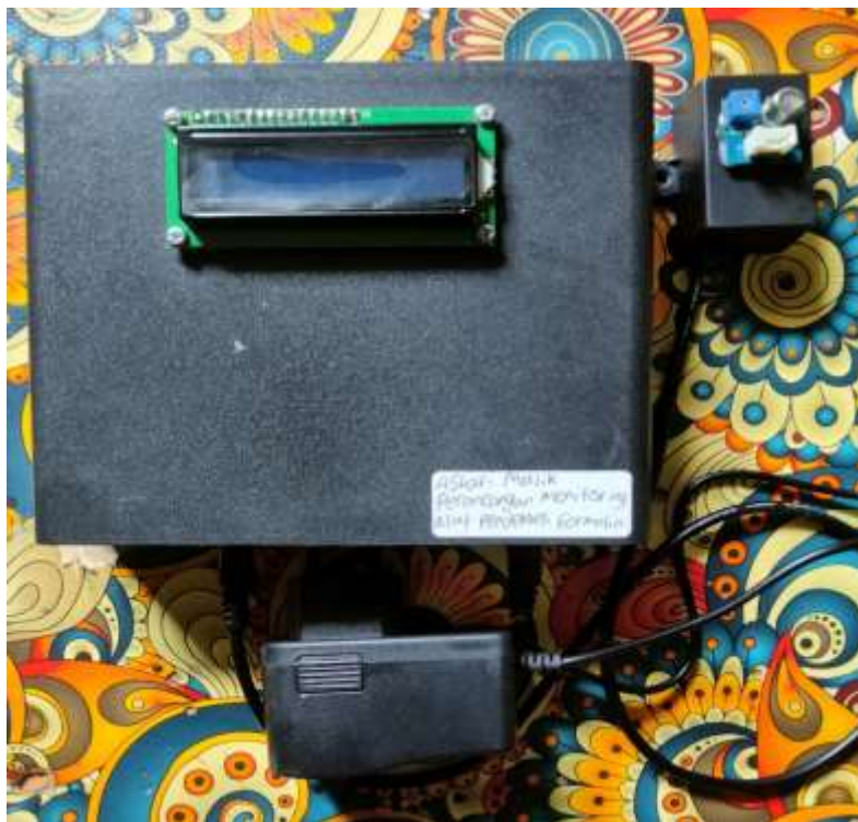
Gambar 5.1 Alat pendeteksi formalin pada bahan makanan
