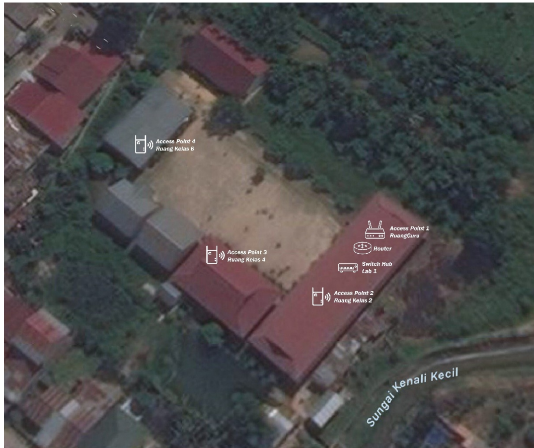
Gambar 5.2 Denah Alat Jaringan Setelah Implementasi HTB
