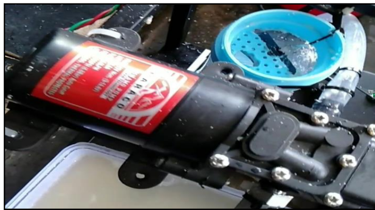
Gambar 5.5 Hasil Implementasi Pompa Penghisap
