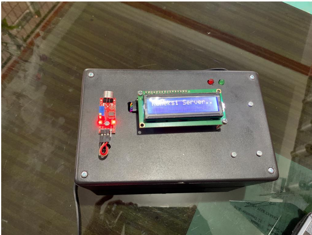
Gambar 5.1 Prototype Alat Ukur Tingkat Kebisingan Suara
