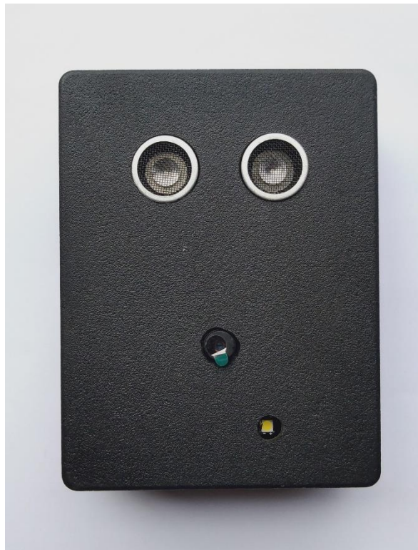
Gambar 5.1 Prototype Alat Sistem Deteksi Dini Pada Pergerakan Objek
