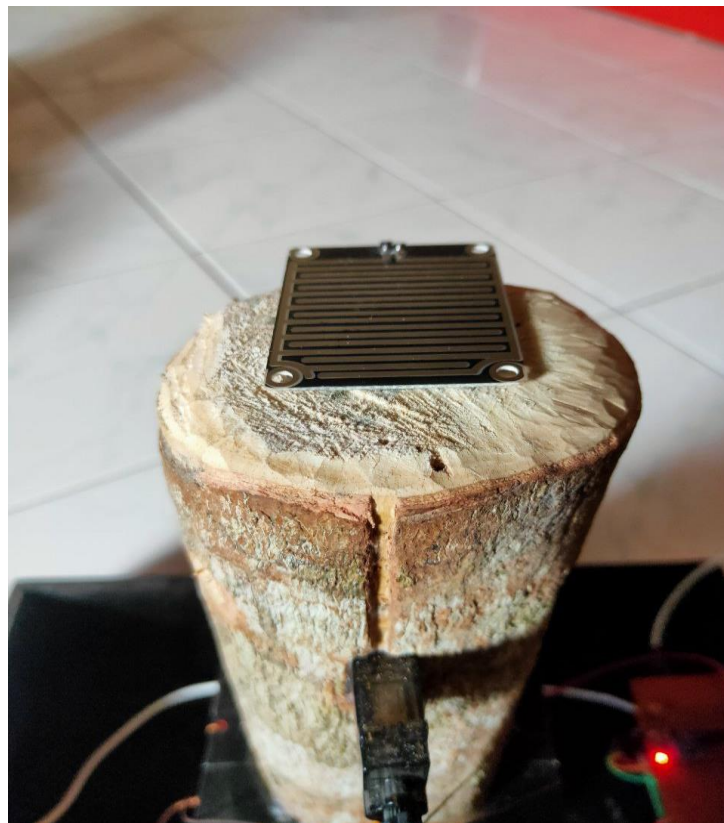
Gambar 5.2 Sensor raindrop tidak mendeteksi adanya air hujan
