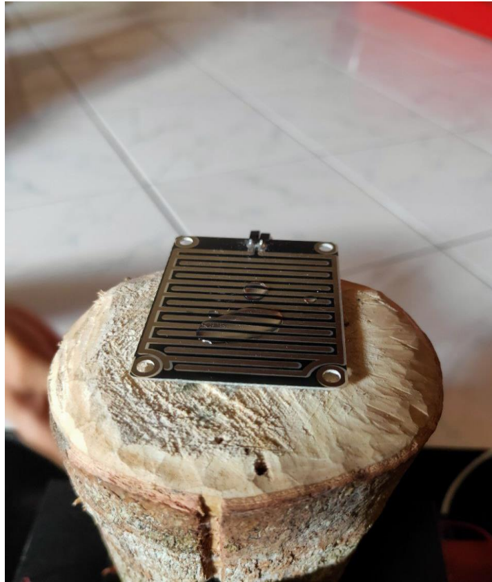
Gambar 5.4 Sensor raindrop mendeteksi adanya air hujan
