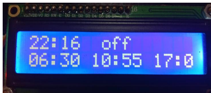
Gambar 5.8 Hasil Karakter LCD16x2
