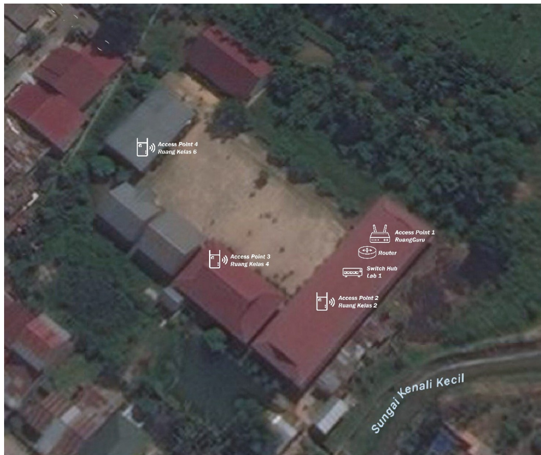
Gambar 5.2 Denah Alat Jaringan Setelah Implementasi HTB
