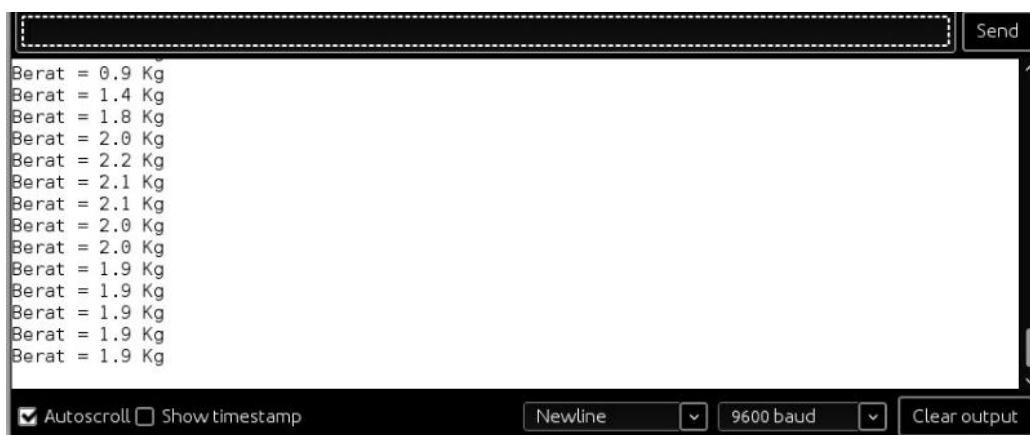
Gambar 5.4 Tampilan Serial Ketika Sensor Load cell Diberikan Tekanan
