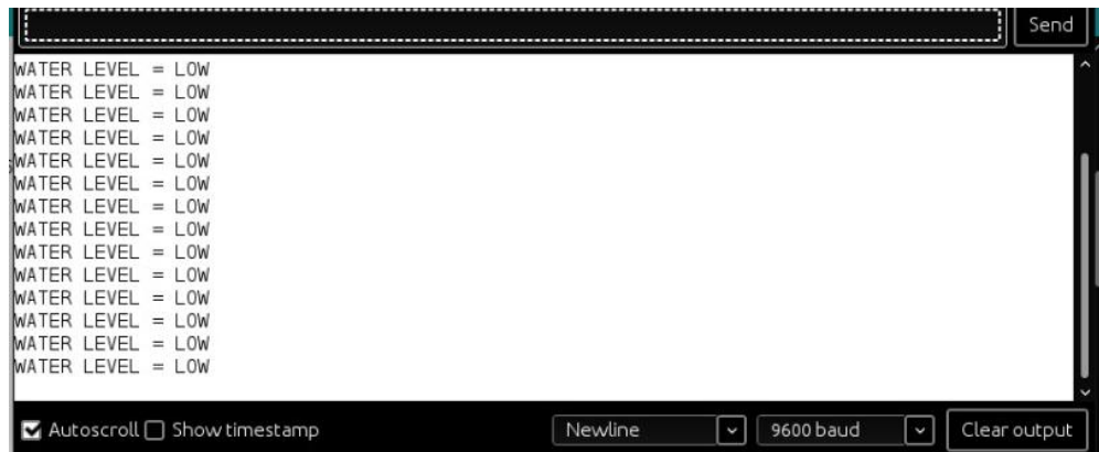
Gambar 5.8 Tampilan Serial Ketika Sensor Water Level Membaca Sedikit Air
