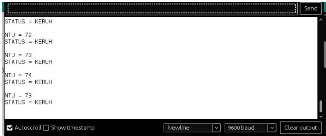
Gambar 5.7 Tampilan Serial Ketika Sensor Turbidity Membaca Air Keruh
