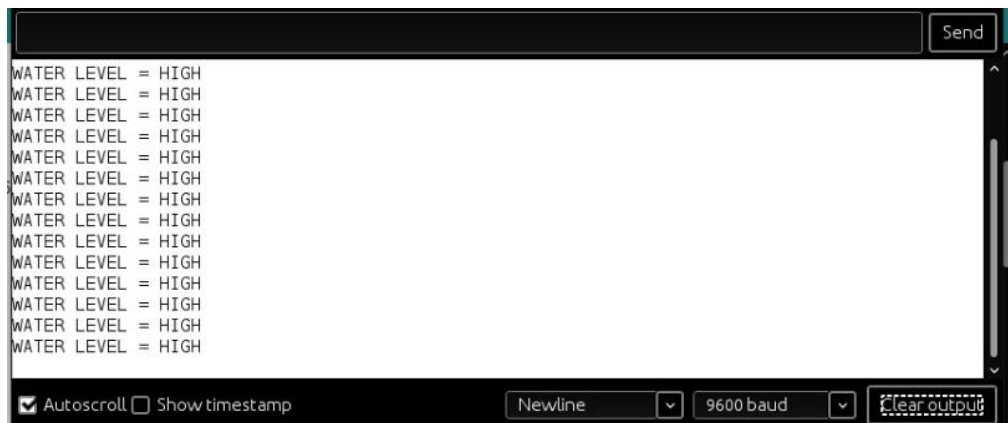
Gambar 5.9 Tampilan Serial Ketika Sensor Water Level Membaca Banyak Air
