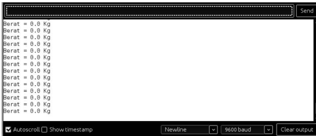
Gambar 5.3 Tampilan Serial Ketika Sensor Load cell Dalam Keadaan Standby
