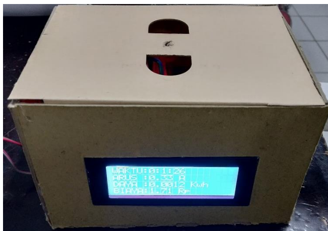
Gambar 5.22 Bentuk Fisik Pemonitoring Penggunaan Daya Listrik
