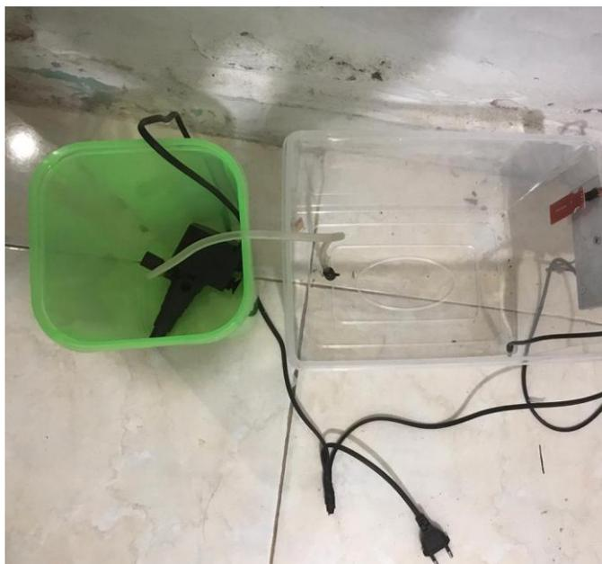
**Gambar 5.3 Kotak Air dan Pompa Air**
