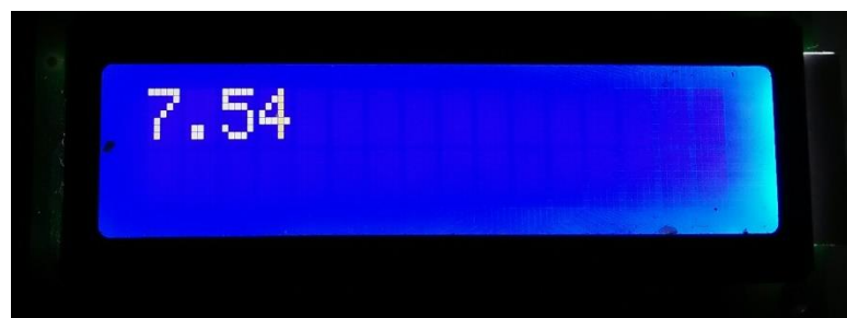
Gambar 4.18 Keluaran sensor pH pada LCD 16 x 2
