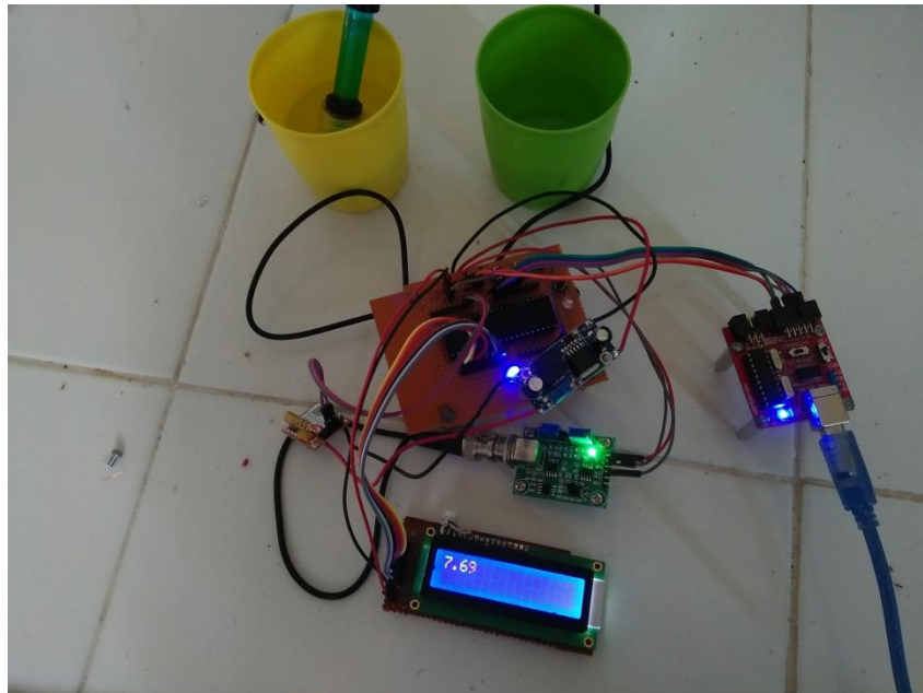
Gambar 5.1 Bentuk Fisik Perancangan Monitoring Kualitas Air Pada Budidaya Kolam Ikan
