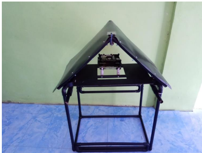
Gambar 5.1 Alat tempat pendeteksi hujan dan pengangkat pakaian otomatis
