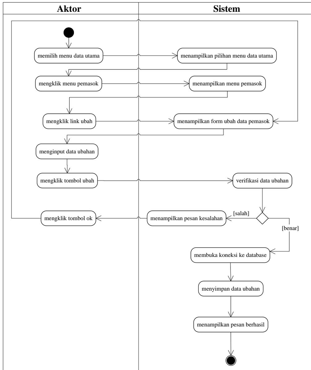
**Gambar 4.19 Activity Diagram Mengubah Data Pemasok**
