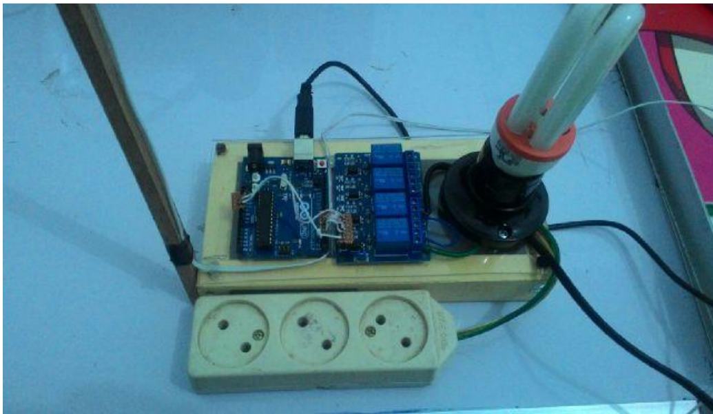
Gambar 5.1 Sistem Pengontrolan Peralatan Rumah Tangga
